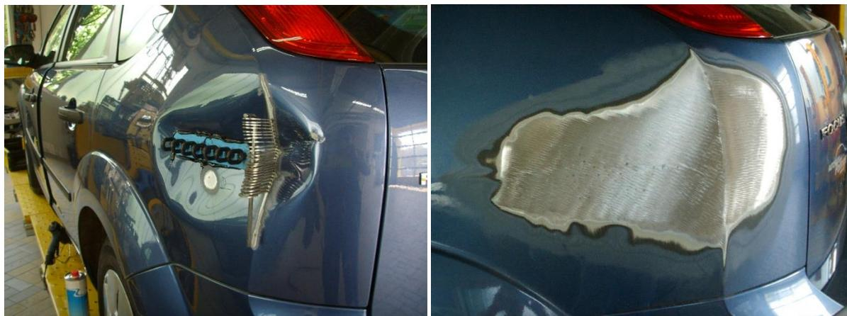
*Seitenwandreparatur an einem Ford Focus ohne Ersatz der Seitenwand.*
