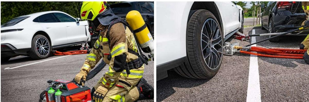
*Möglichkeiten zum Anheben eines E-Fahrzeugs zur Kühlung der Batterie oder zum Positionieren von Brandschutzdecken. Quelle: Rosenbauer.*
