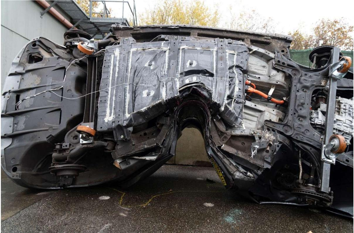
*Beispiel für eine massiv deformierte HV-Batterie, die von der Feuerwehr zu beobachten ist. Quelle: Dekra.*
